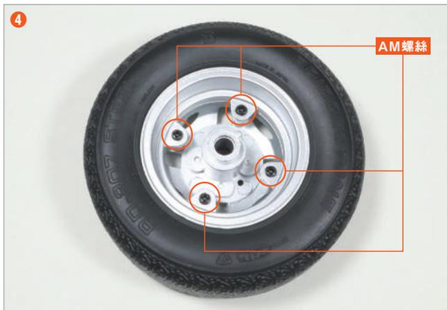
壓住兩側輪圈以防止其滑動的同時，使用 **AM 螺絲** 固定四個位置。
