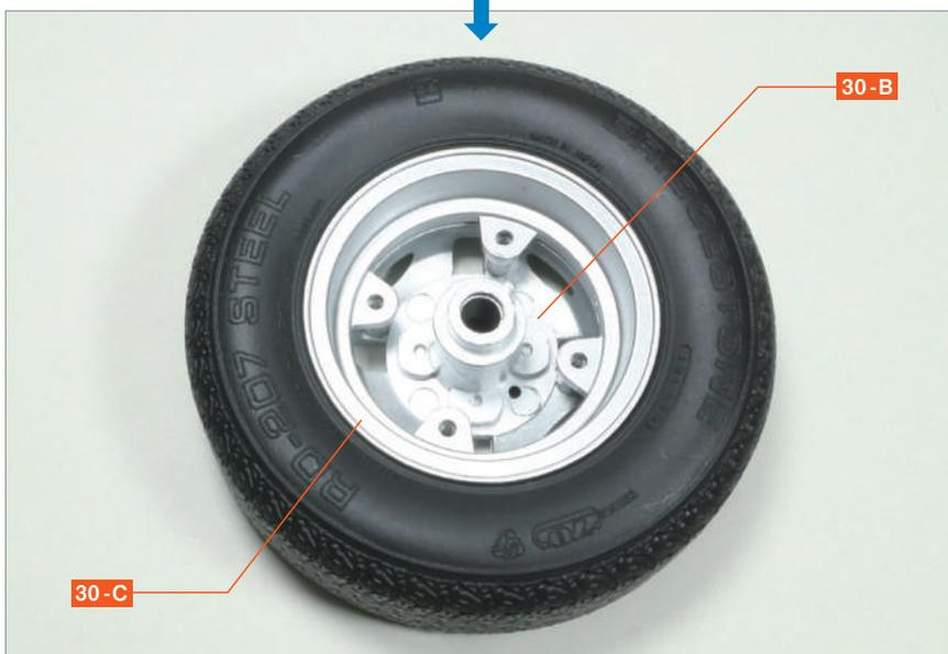
將 30-B 壓住以防止其脫落，並將其翻至正面。將內側輪圈 30-C 背面的凹槽與 30-B 螺絲孔的突起部分對齊，然後將其嵌入。
